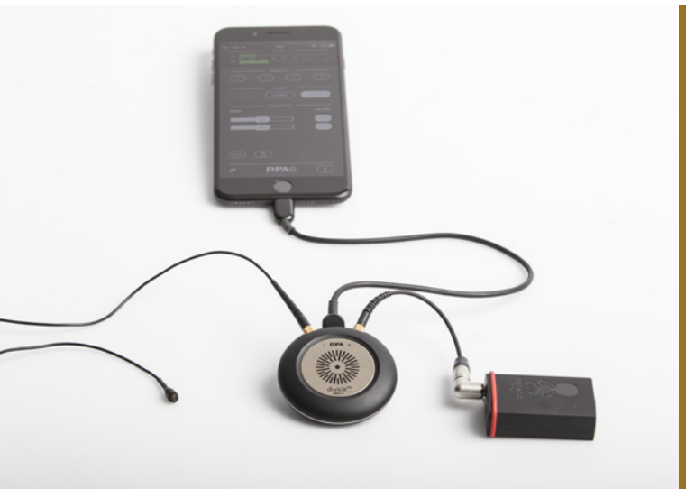
DPA d:vice er her tilsluttet både en 4060 mikrofon og en lille synkroniseringsenhed fra Tentacle.
