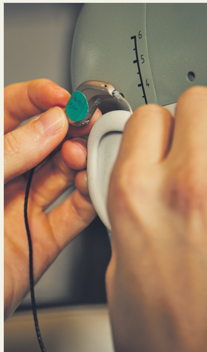
Demants specialister tester lydkvalitet og brugeroplevelse ved at finjustere høreapparater på realistiske øremodeller. På den måde sikres optimal lydkvalitet for brugeren.
